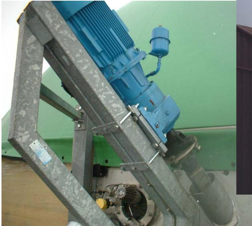
Gegen Schwingungen gesichertes Rührwerk
