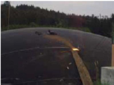
Bild 9: 5. Brandversuch, Biogasaustritt aus dem entstandenen Loch durch die brennende Gartenpartyfackel; ein benzingeränkter Lappen wird zusätzlich auf den Foliengasspeicher geworfen
