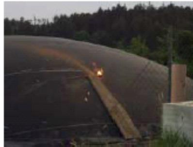
Bild 7, 8 + 9: 5. Brandversuch mit einer brennenden Gartenpartyfackel
