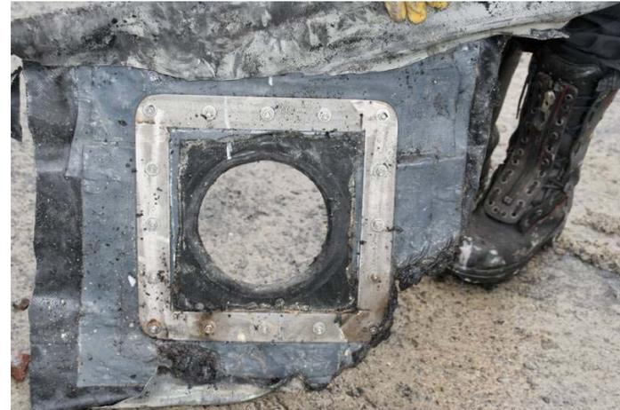
**SV Dietrich: Undichtigkeit Flansch am Gassack sowie folgende Wanddurchführungen**
