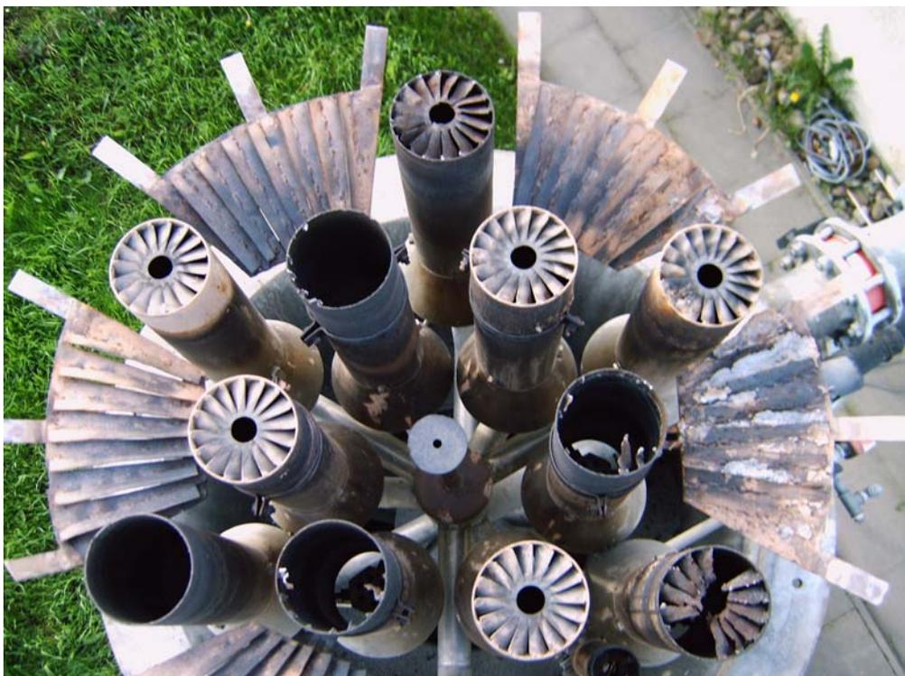
**Abbildung 1:** Beispiel Brenner mit beschädigten Brennerdüsen (1) [Foto: Stachowitz, 2005]
