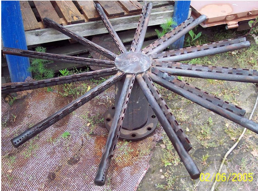
**Abbildung 2:** Beispiel Brenner mit beschädigten Brennerdüsen (2) [Foto: Stachowitz; 2005]
